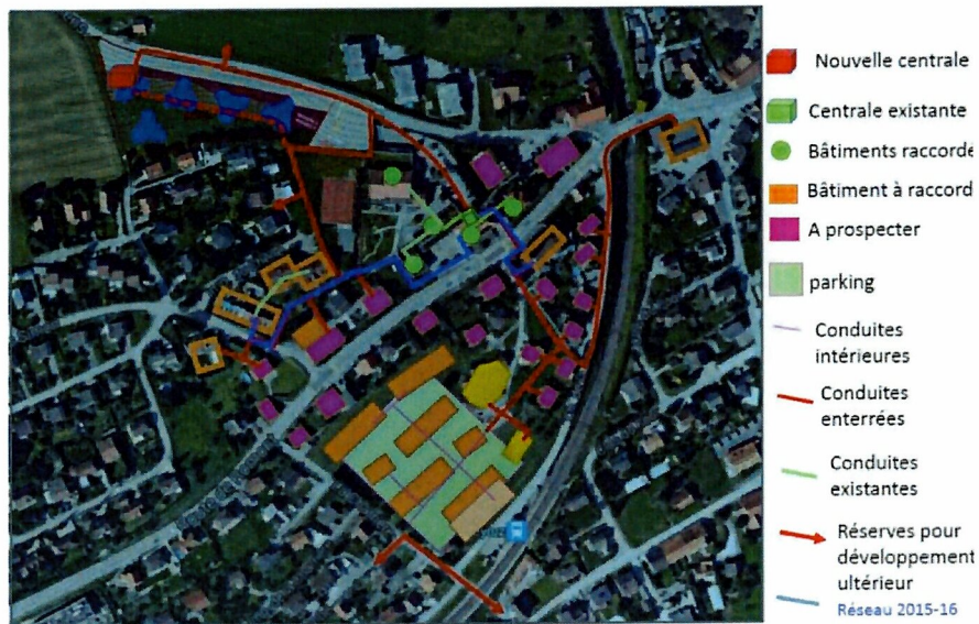
Figure 4 Représentation du réseau CAD et de son développement à moyen terme
